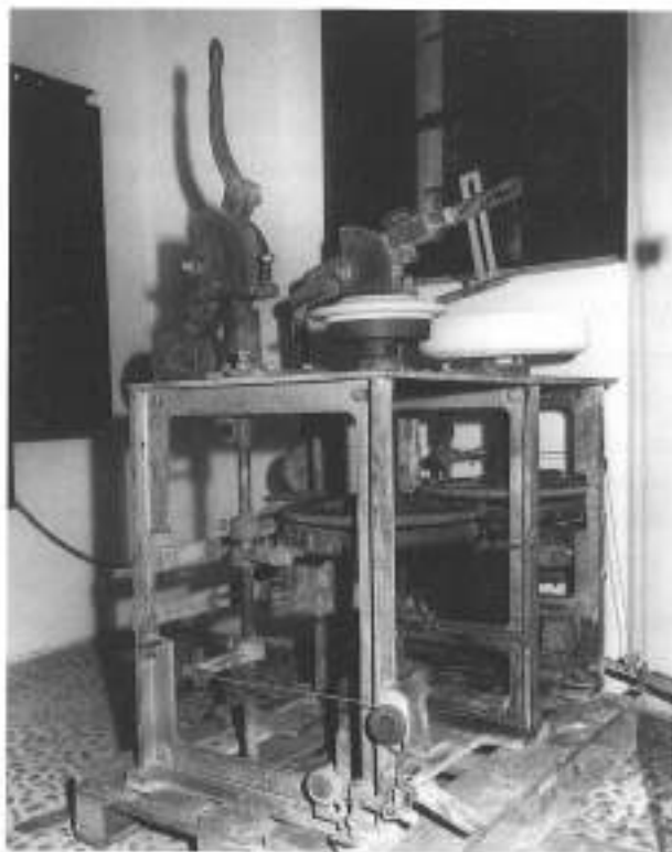
Máquina para hacer platos construida en Oviedo, por Guillermo Feito, hacia 1925, usada hasta 1965 aproximadamente.
